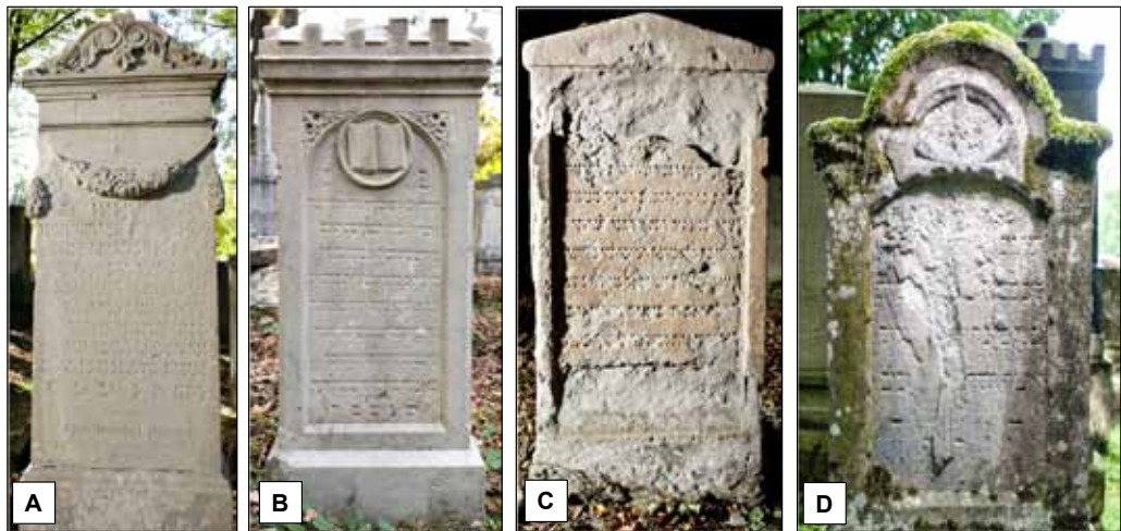
▲ Abb. 4. A (Grabstein Nr. 236): Feinkörniger, gut verfestigter graugrüner Keupersandstein. B (Grabstein Nr. 322): Graubrauner, gut verfestigter, feinkörniger Sandstein. C (Grabstein Nr. 442): Grauer, intensiv verwitterter, feinkörniger Sandstein mit Schalenbildung, Abschalen, Abplatzen. D (Grabstein Nr. 254): Graugrüner, feinplattiger, stark verwitterter, schräg angeschnittener Sandstein, feinplattiges Absanden, und Aufquellen.
