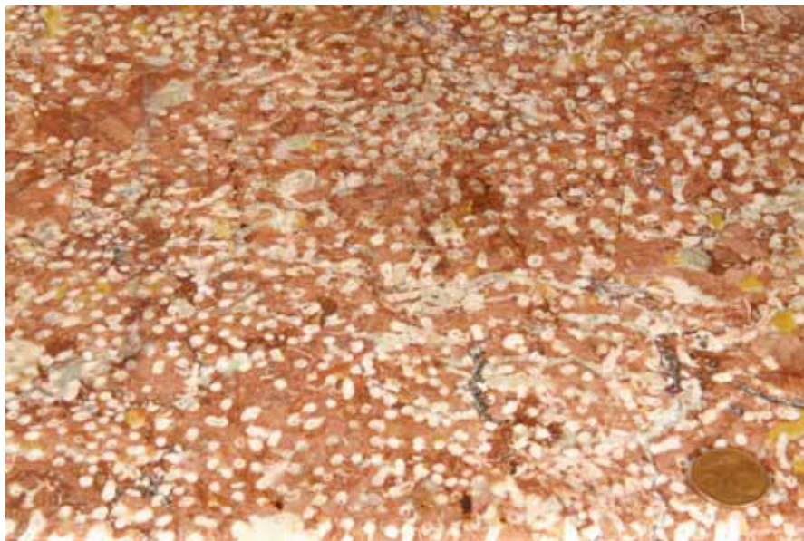
▲ Abb. 11 (zu Stopp 2; oben). Der obertriassische Korallenkalkstein „Adneter Rottropf“ aus dem Bundesland Salzburg in Österreich wurde für die Balustrade der barocken Chorschranken verwendet. Die umlaufende Stufe besteht aus dem roten Lienbacher Kalkstein mit gebleichten Bereichen (Unterjura), ebenfalls aus Adnet.
